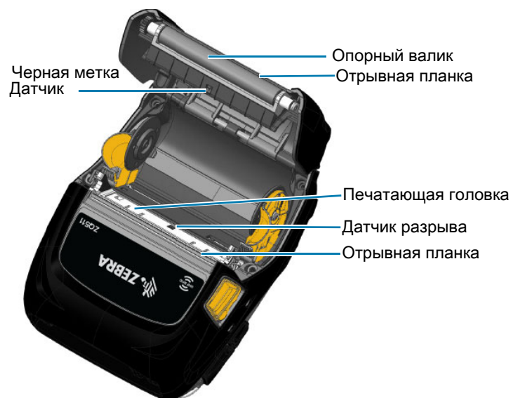
Рис. 39 Места очистки (принтер для носителей с подложкой)
