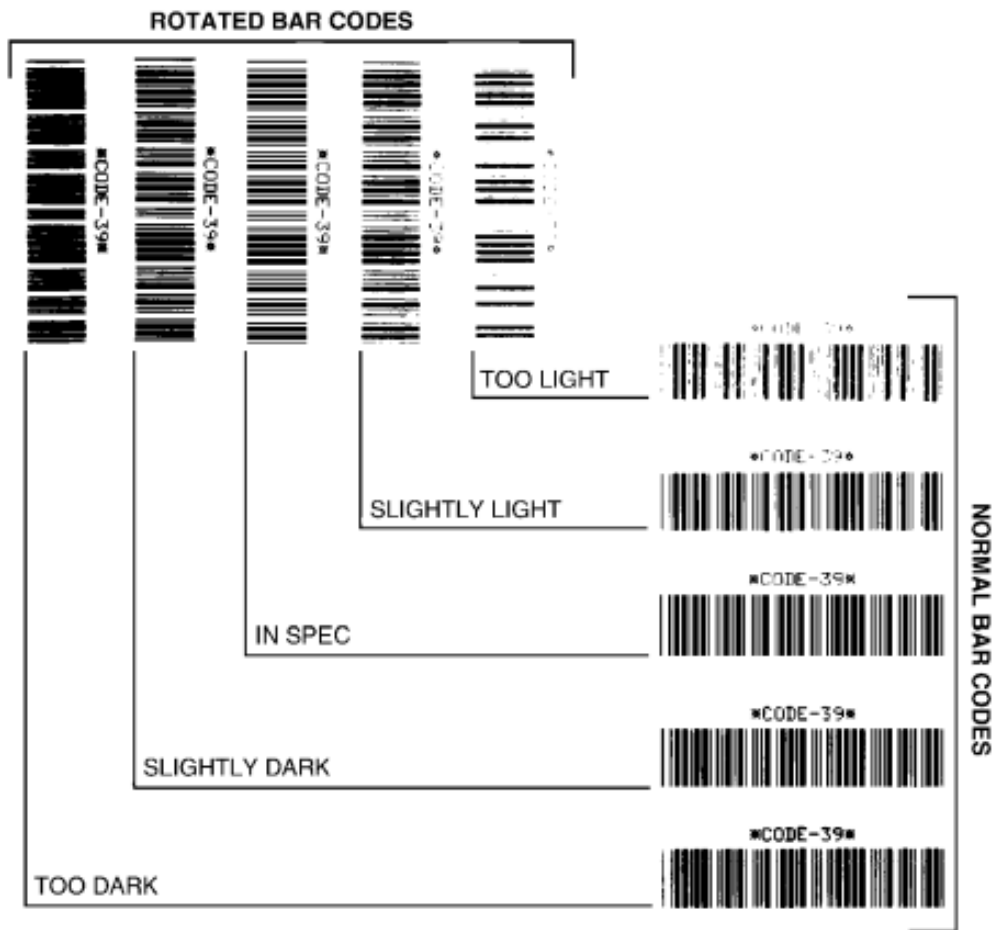
Рисунок 8 Сравнение интенсивности печати штрихкодов
