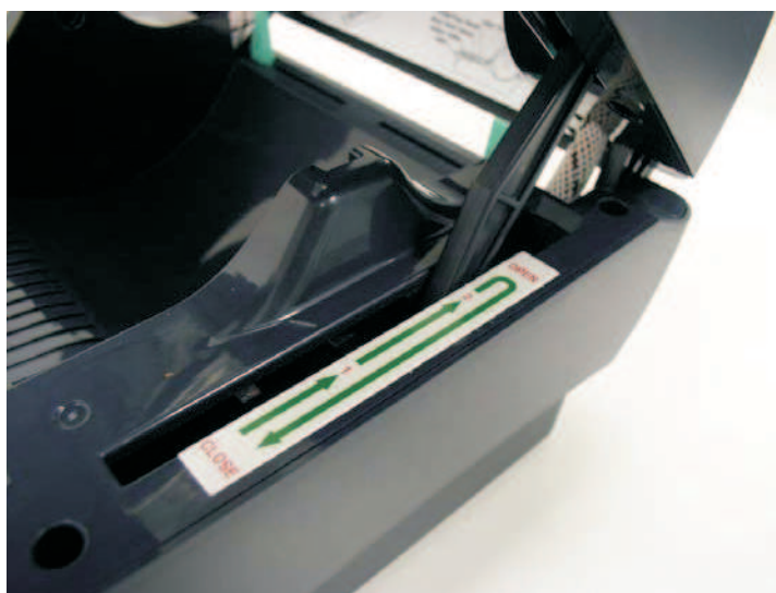
Рис. 1 Опора верхней крышки зафиксирована в положении 2
