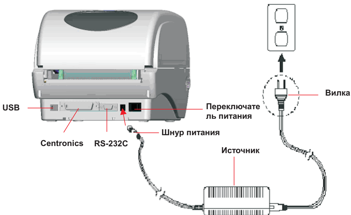
Рис. 3. Подключение источника электропитания к принтеру
