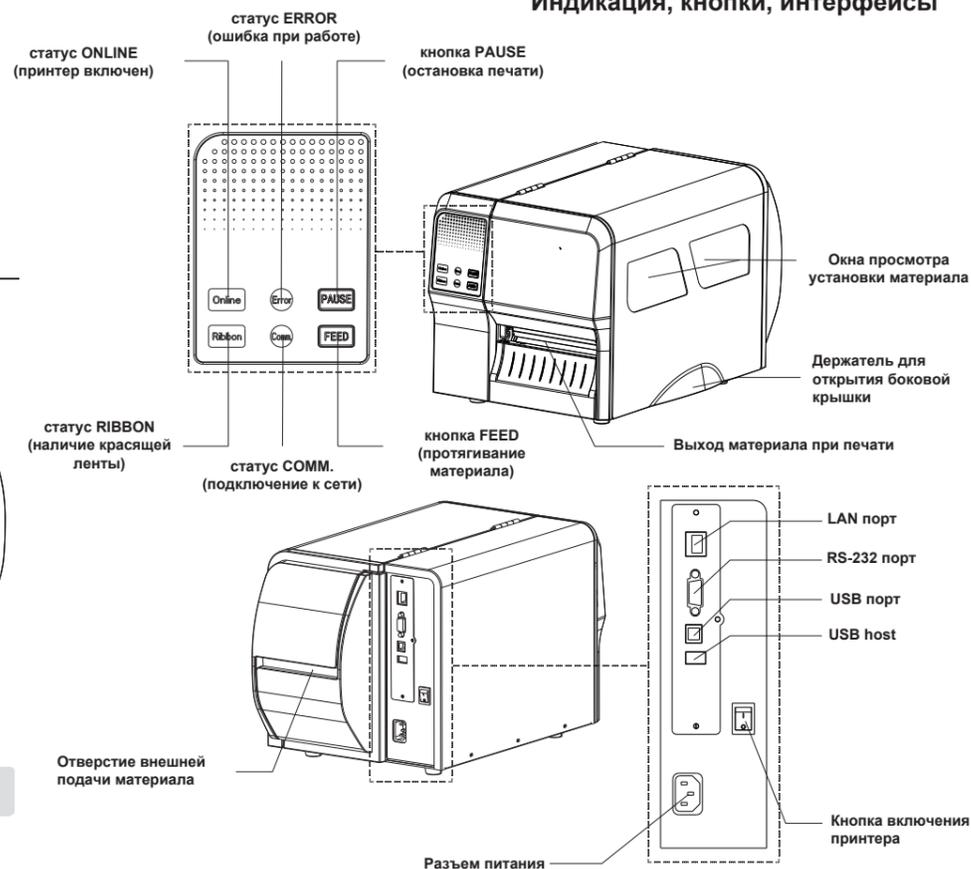
Примечание: У моделей версии Plus другая структура передней панели. Имеется 3-х цветный индикатор со статусами ONLINE, ERROR, RIBBON, единая кнопка с функционалом FEED/PAUSE, цветной дисплей для настройки принтера и вывода информации об ошибках.
